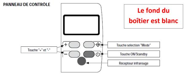
IMPORTANT: la programmation doit être faite dans les 8 secondes après la mise sous tension du thermostat. Si la manipulation est faite APRES ces 8 secondes, elle active/désactive la fonction "fenêtre ouverte"
